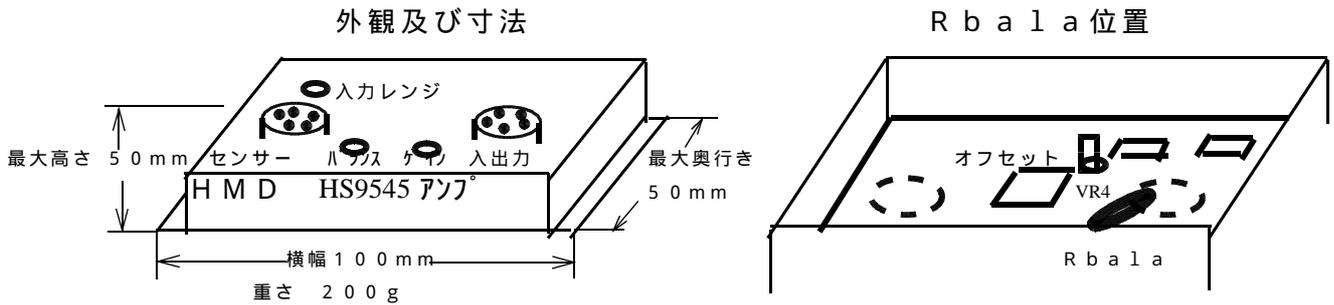
HS9545AMP - Rレンジ付き動ひずみアンプのオフセット調整方法を示します。
