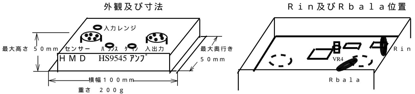
HS9545AMPは低ノイズの動ひずみアンプで、ゼロバランス及び出力ATT調整(ゲイン)が出来るコンパクトなアンプです。-Rはレンジ付きで、標準100~5000倍です。尚、下記で示す mV/V は、2000倍した数値が、ストレン表示(μs)となります。120 ひずみゲージに接続する場合は、専用ブリッジケーブルを使用します。バリダイン社の差圧計DP15、DP363等は、専用ケーブルを使用します。
