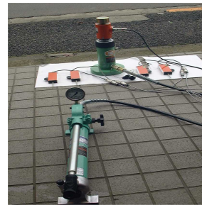
荷重計(ロードセル)、変位計*4、ジャッキー、油圧ポンプ
